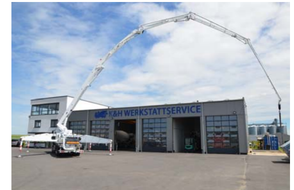
Die neue Betonpumpe mit einer maximalen Höhe von 47m
